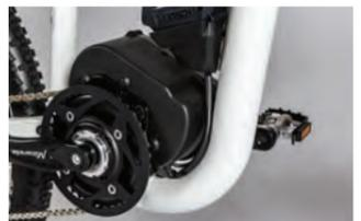
EMI ("elevated Motor integration") für optimalen Motorschutz und Schwerpunkt
