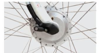
Allradantrieb durch Frontnabenmotor
