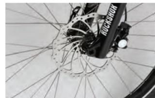
hydraulische MAGURA MT4 Scheibenbremse mit 203 mm Scheiben und Bremslichtschalter
