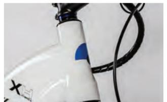
supersteifer 1.5 Steuerkopf mit angepassten "Taper"-Gabeln
