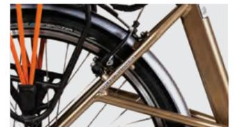
Mit Rücktrittbremse und 2 V-brakes
