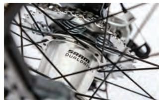
SRAM Dual drive 27 Gangschaltung mit 576% Übersetzung
