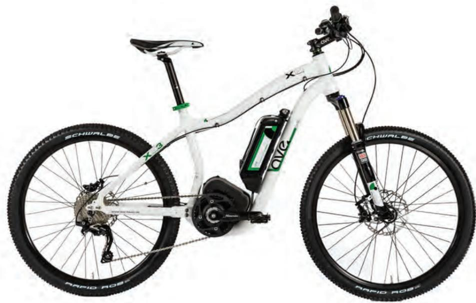
Ein 29er mit integriertem Mittelmotor, die perfekte Kombination abseits asphaltierter Wege!
