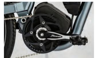
BOSCH 45 S Motor bis 45 Km/H Topspeed
