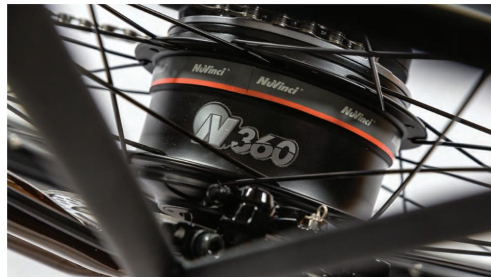
stufenlose NuVinci Nabenschaltung mit 360 % Übersetzung
