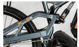
Active Eingelenkschwinge, komplett Kugelgelagert immer unter Kontrolle durch den Rock Shox Monarch RT3 mit Lockout
