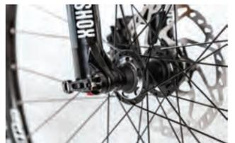
15 mm Steckachsen und 1.5" Steuerkopflagerungen sorgen für Stabilität und Lenkpräzision
