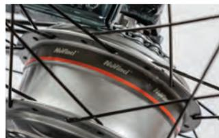
stufenlose NuVinci Nabenschaltung mit 360 % Übersetzung
