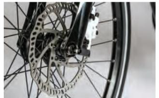
hydraulische TEKTRO Scheibenbremsen mit 180 mm Durchmesser
