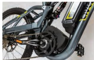
EMI ("elevated Motor integration") für optimalen Motorschutz und Schwerpunkt
