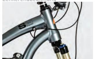
supersteifer 1.5 Steuerkopf mit angepassten "Taper"-Gabeln
